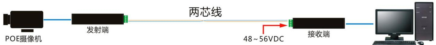
**注: 产品不支持PoE供电模块输入, 包括PoE交换机、PoE硬盘录像机等。只接受48~56VDC电源输入。在传输PoE时, 线缆会出现损耗, 根据线缆的规格有所差异, 如RVV2×0.75mm<sup>2</sup>的线缆有效传输距离约600米。**
