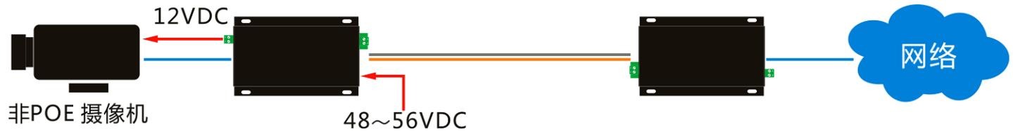
4、主端电源 12VDC 接入时，若因距离远造成电压降过大无法满足从端设备的要求，也可在从端模块处接入电源（12VDC）以作补充。
